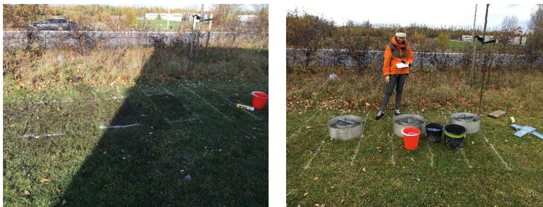
Figur 1. De 4 prøvebaner lige efter etablering, samt måling af jordens infiltrationsevne med ringinfiltrometer
